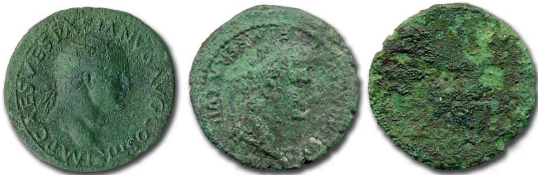
Abb. 9 Fortschreitender Lochfraß bei Münzen unter gleichzeitigem Rekristallisieren der Patina
