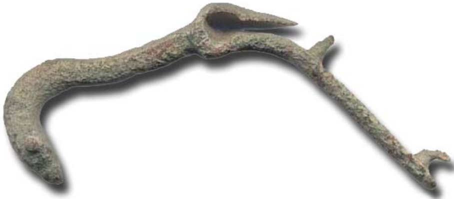
Abb. 2. Mechanisch deformierter römischer Riemenhaken mit starkem Lochfraß
